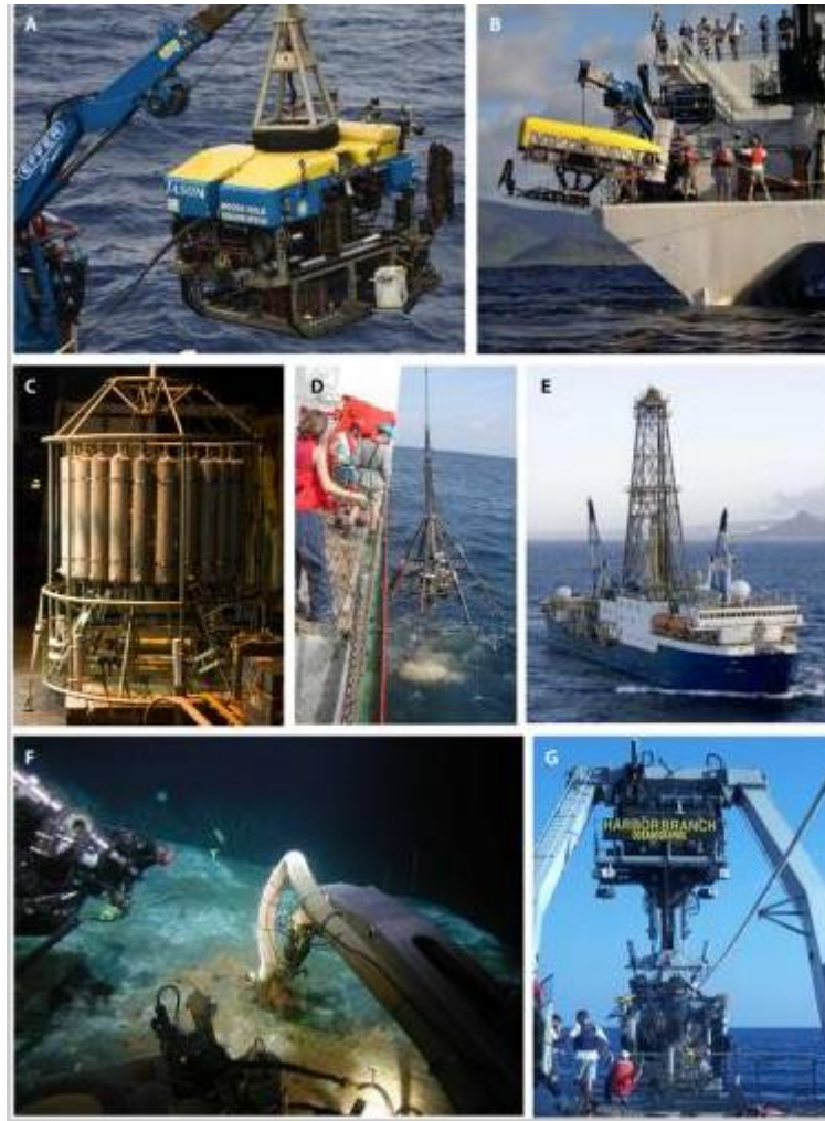
Figure 28. Photographies d'outils d'échantillonnage couramment utilisés pour la recherche sur les océans profonds. (A) ROV Jason II, Woods Hole Oceanographic Institution. (B) ROV/AUV Nereus, Woods Hole Oceanographic Institution. (C) Rosette de bouteilles d'échantillonnage d'eau Niskin et ensemble de capteurs CTD (conductivité, température, profondeur). (D) Dispositif à anneaux multiples pour recueillir les sédiments de surface. (E) Navire scientifique de forage océanique RV JOIDES Resolution pour la collecte de sédiments profonds et de roches dures. (F) Vue de l'intérieur du submersible Johnson SeaLink, Harbor Branch Oceanographic Institute, travaillant à une infiltration de froid dans le golfe du Mexique. (G) Lancement du submersible Johnson SeaLink, Harbor Branch Oceanographic Institute. (Panneaux A et C gracieuseté de J. Sylvan; panneau B gracieuseté de Robert Elder, droit d'auteur de l'Établissement océanographique de Woods Hole; panneaux D et G gracieuseté de B. Orcutt; panneau E gracieuseté de William Crawford, IODP/TAMU; panneau F gracieuseté de I. R. MacDonald.) (Orcutt et al., 2011).
